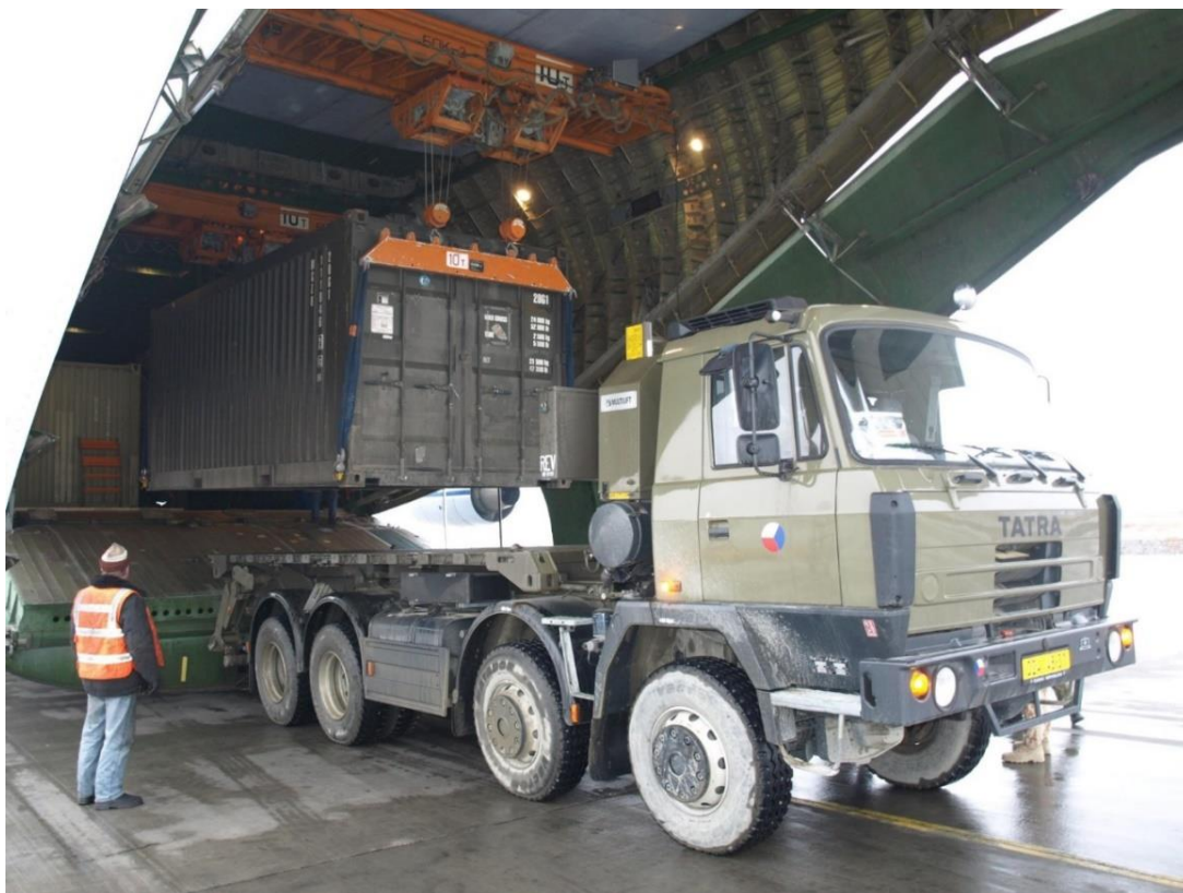
Obr. 1.4 – T-815-2 Multilift Mk.IV a možnost převozu kontejneru
