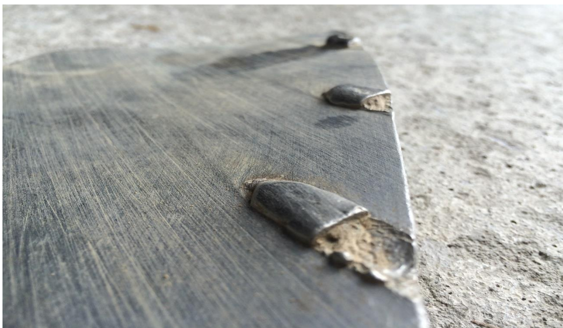
Obr. 3 Rýhování plužní čepele a vylomení návaru vlivem působení abrazivních částic a rázů
