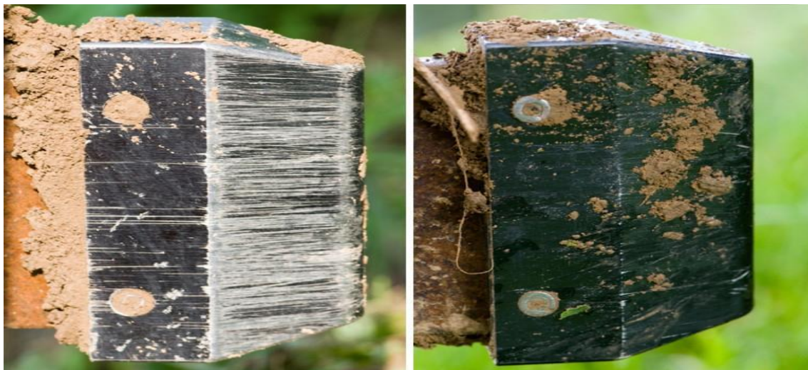
Obr. 14 Polní zkouška u špičky radlice (vlevo bez povlaku, vpravo s povlakem)
