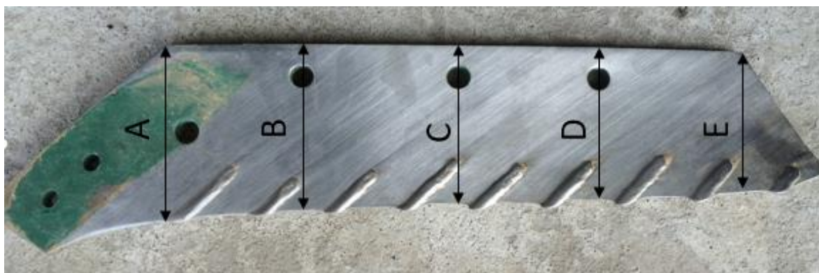
Obr. 1 Metodika měření jednotlivých rozměrů plužní čepelce
