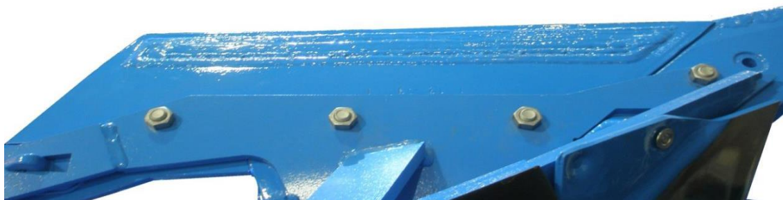
Obr. 12 Vodorovný návar na zadní straně čepele společnosti Lemken
