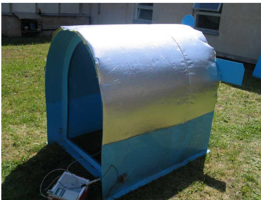
Obr. 16: Varianta 3 - VIB pokryta 50mm vrstvou minerální vaty a AB parozábranou s hliníkovou fólií
