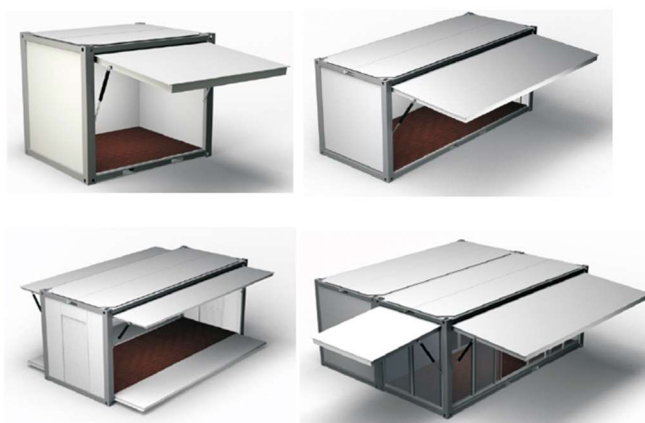
Obr. 2.7 Možnosti vyklopení bočnic [11]
