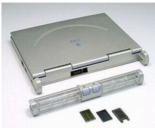
Obrázek 3 : příklad realizace napájení notebooku palivovým článkem [10]
