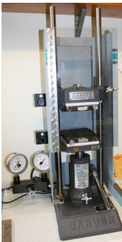
Obrázek 25 : lis Carver s měřením zatížení a vyhříványými lisovacími plotnami
