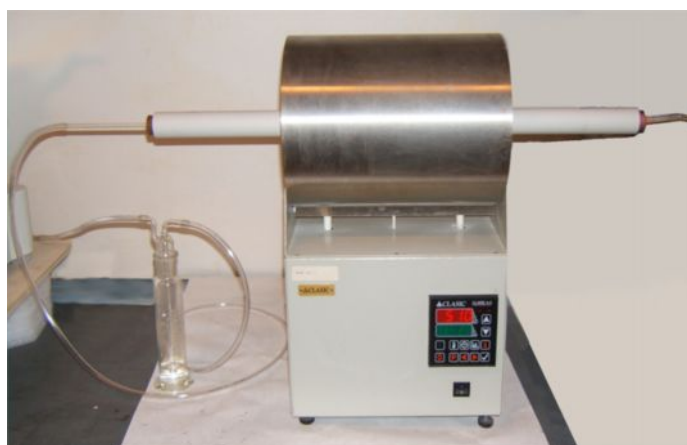
Obrázek 11 : Pec pro žhání v atmosféře oxidu uhličitého [5]
