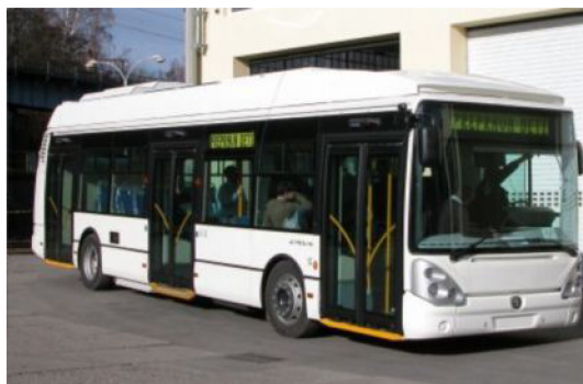
Obrázek 5 : Autobus na vodíkový pohon, který od roku 2006 vyvíjí Ústav jaderného výzkumu v Řeži u Prahy [12]
