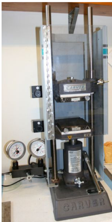
Obrázek 25 : lis Carver s měřením zatížení a vyhřívanými lisovacími plotnami
