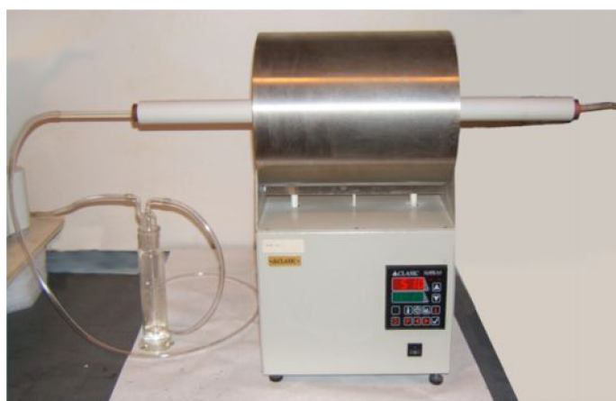
Obrázek 11 : Pec pro žihání v atmosféře oxidu uhličitého [5]
