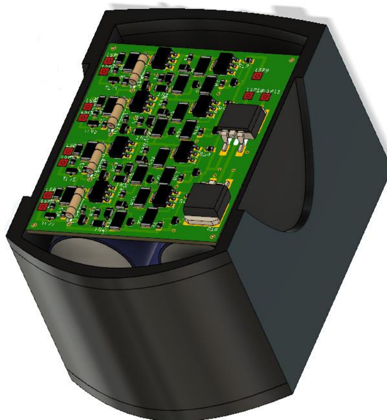
Obr. 9-5 Usazení desky plošných spojů v akumulátorovém pouzdře s lithiovými články
