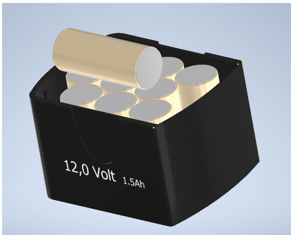
Obr. 6-1 Zástavba původních NiCd článků v pouzdře
