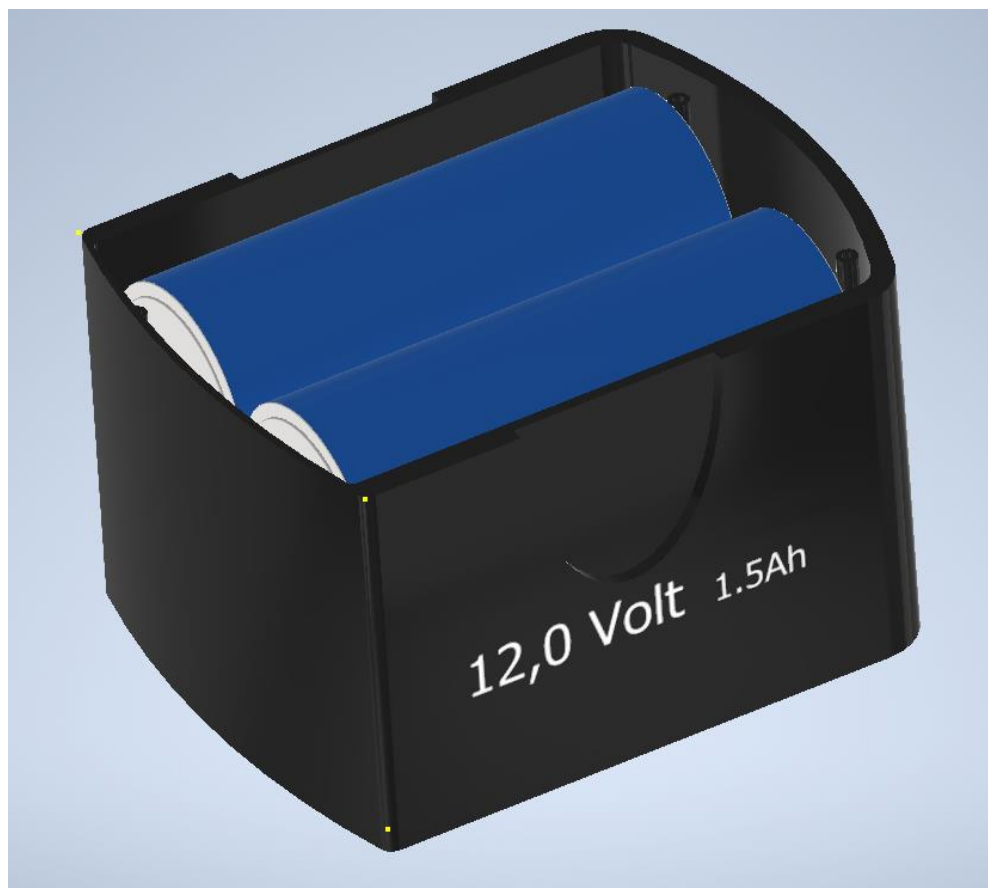
Obr. 6-2 Zástavba nových LiFePO4 článků v pouzdře
