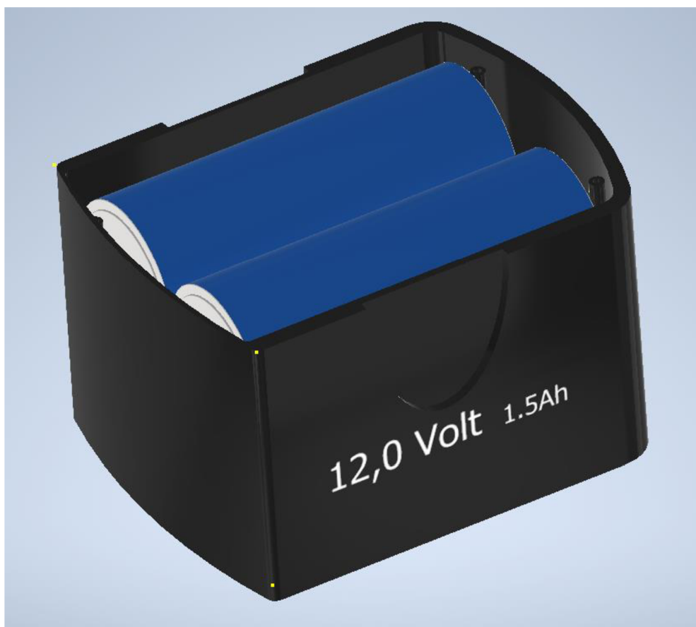
Obr. 6-2 Zástavba nových LiFePO 4 článků v pouzdře
