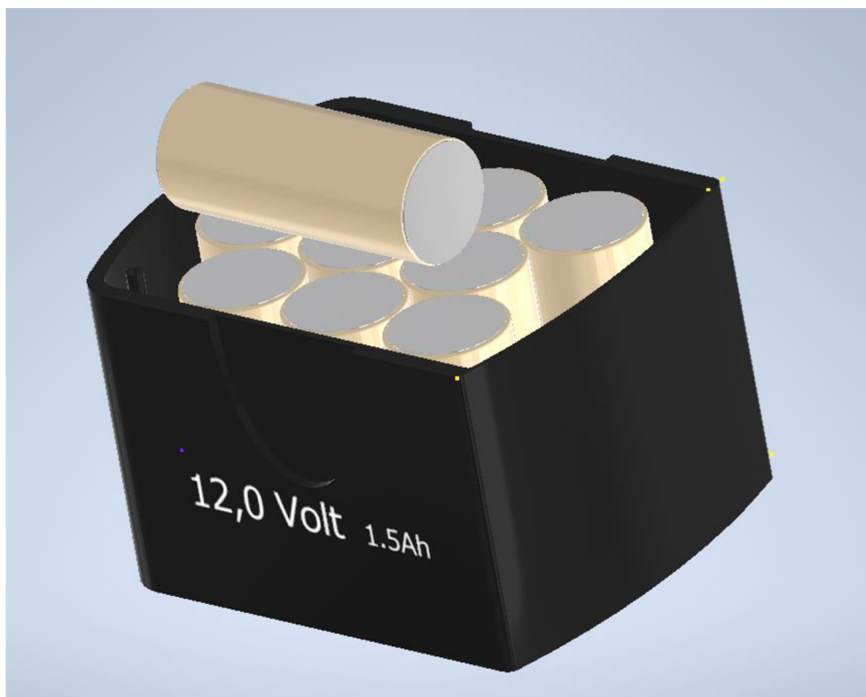
Obr. 6-1 Zástavba původních NiCd článků v pouzdře
