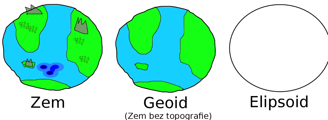
Obr. 2.5: Ukážka prepočítavania reálnych lokácií do geodetických systémov. Miesta na zemi sú zarovnané ku geoidu a prenesené do elipsoidu. Adaptované z [31].
