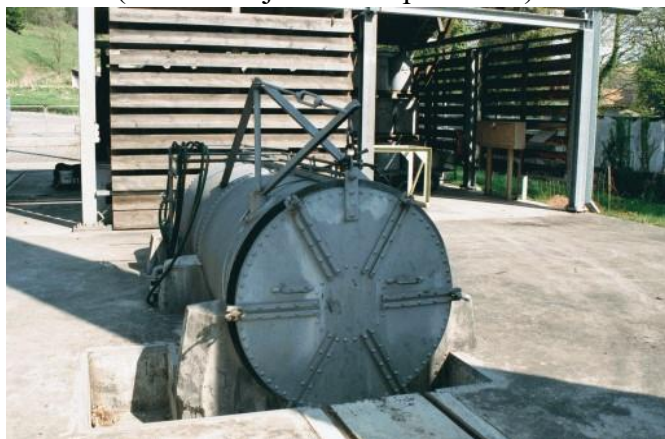
Obrázek č. 3: Plechový sud na výrobu dřevěného uhlí (Poudrierie & Aubonne 2010)
