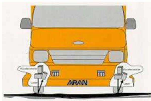
Obrázek 4 – vozidlo proměření podélných nerovností. Zdroj: http://www.viageos.cz/tech_udaje.asp
