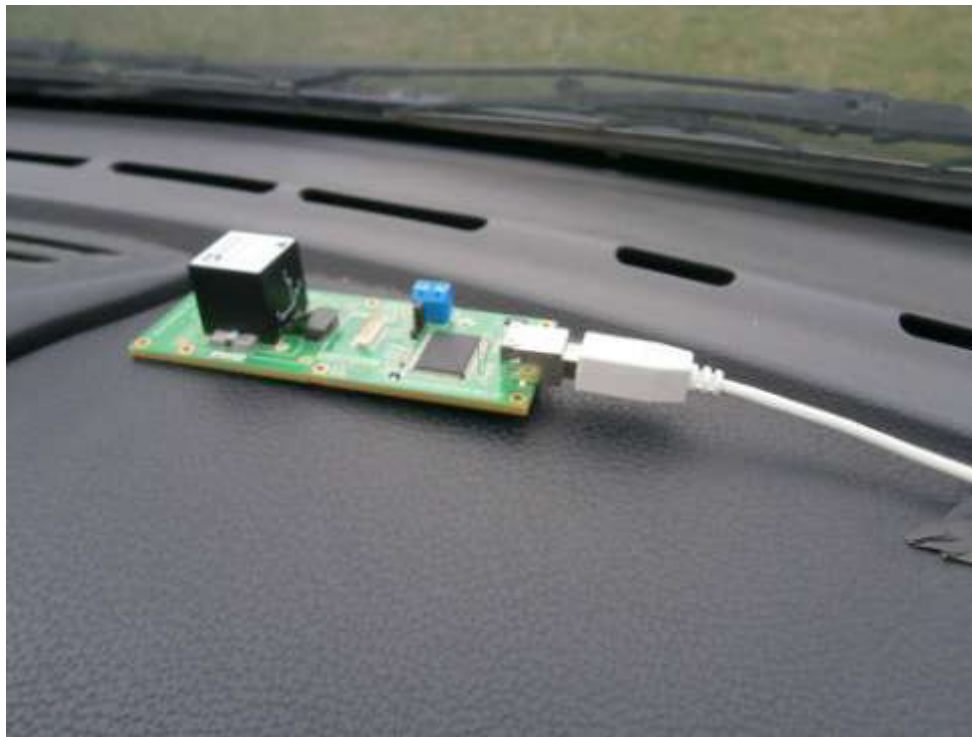
Obrázek 8 – Připevnění IMU na palubní desce
