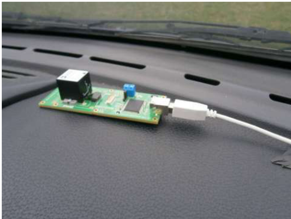
Obrázek 8 – Připevnění IMU na palubní desce
