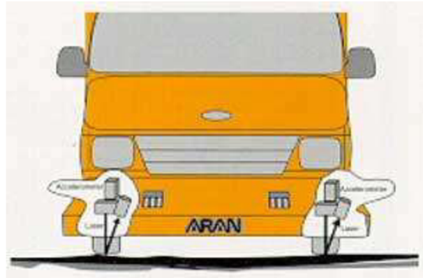
Obrázek 4 – vozidlo proměření podélných nerovností. Zdroj: http://www.viageos.cz/tech_udaje.asp
