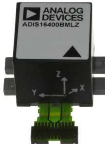
Obrázek 6 – zařízení ANALOG DEVICES ADIS 16400BMLZ
