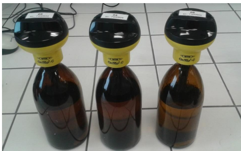
Příloha č. 5: WTW OxiTop OC 110 - aparatura pro měření BSK 5 (FOTO: Krábková)
