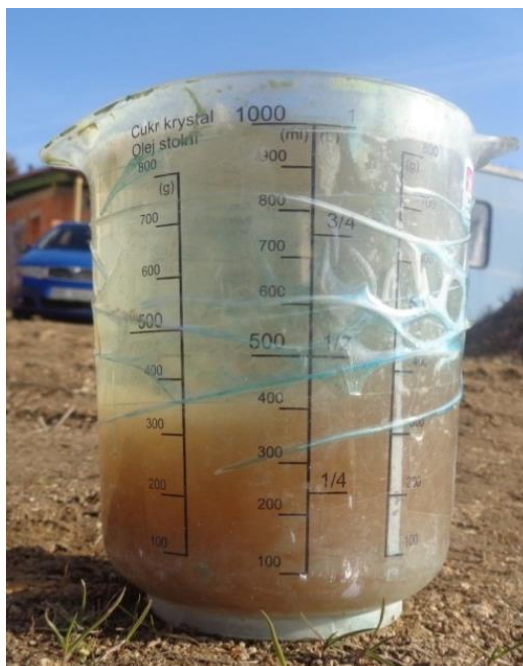
Příloha č. 10: Kalová zkouška u DČOV 1 při měření v březnu 2017 (FOTO: Krábková)
