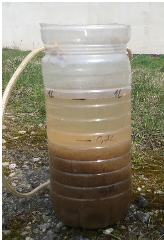
Příloha č. 12: Kalová zkouška u DČOV 2 při měření v březnu 2017 (FOTO: Krábková)
