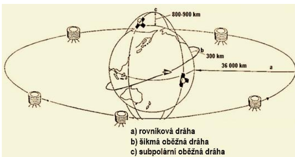
Obr. 7.3: Znázornění typů oběžných drah družic s přibližnými vzdálenostmi od zemského povrchu (Hoffmann, 2014)
