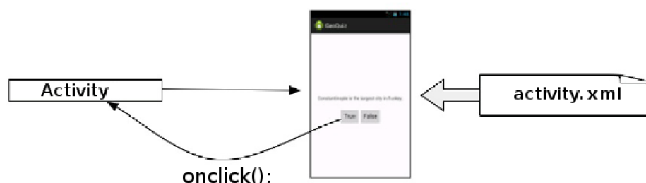
Obrázek 2.1: Vztah mezi podtřídou Activity a Layoutem
