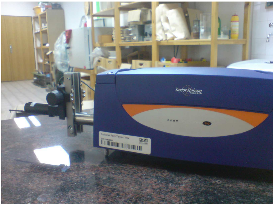
Obr. č. 21: Měřící zařízení, vysunutý snímač s měřícím hrotem
