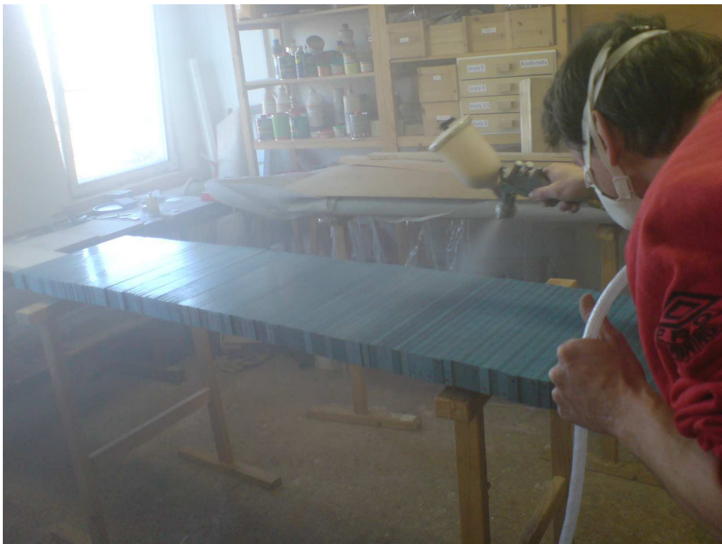
Obr. č. 17: Nanášení první vrstvy nátěrové hmoty
