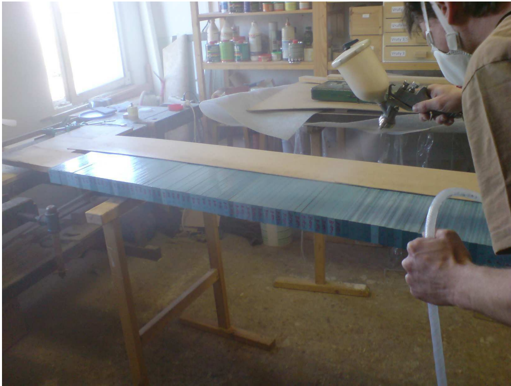
Obr. č. 18: Nanášení druhé vrstvy nátěrové hmoty
