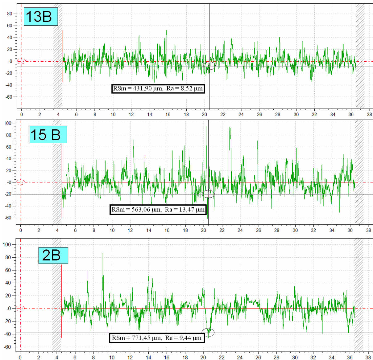
Obr.č.32: Porovnání hodnot R_{Sm} (13B-nejnižší, 15B-průměrná, 2B-nejvyšší hodnota)
