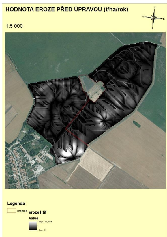
Obr. 12: Výpočet eroze před úpravou
