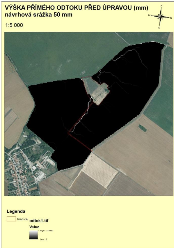
Obr. 16: Výška odtoku v každém bodě před úpravou
