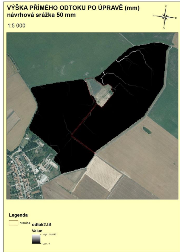
Obr. 15: Výška odtoku v každém bodě po úpravě
