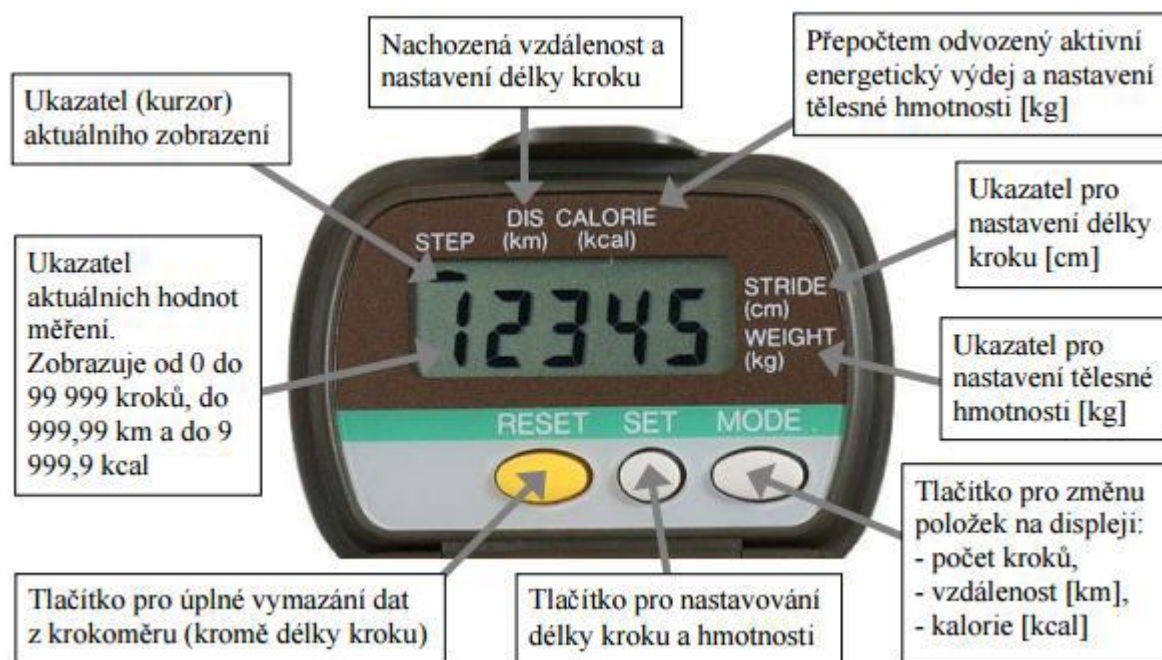
Obrázek 8. Krokoměr Yamax Digiwalker SW-700 s popisem ovládacích prvků (převzato od Sigmunda, 2012, 13)
