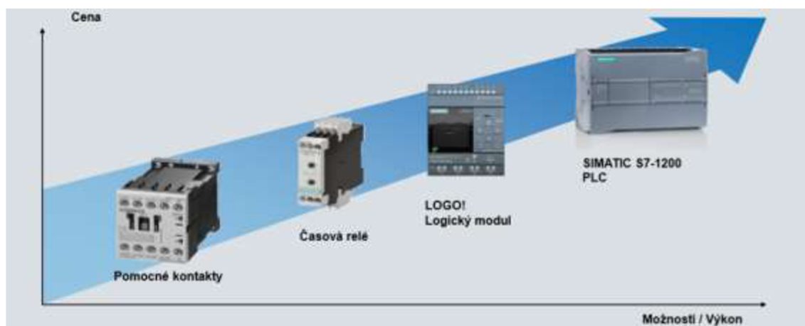
Obr. 1: Pozícia LOGO! medzi štandardnou spínacou technikou [1]
