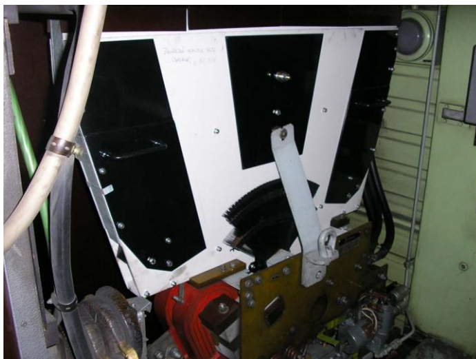
Obr. 2.4: Hlavní vypínač lokomotivy řady 163 [4]
