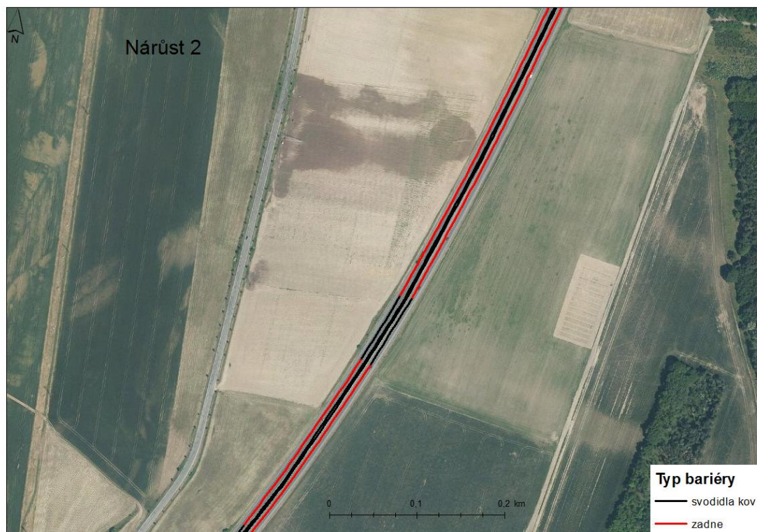
Obr. č. 2: Detail průběhu bariér v druhém místě se zvýšeným počtem nehod. Zdroj: Novák Libor.
