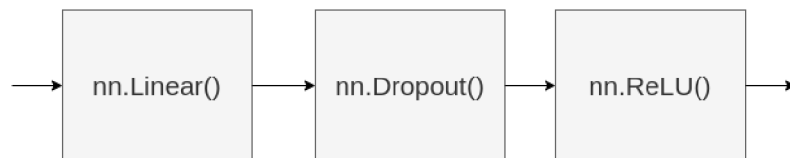
Obrázek 4.8: Složení jedné vrstvy plně propojené části.
