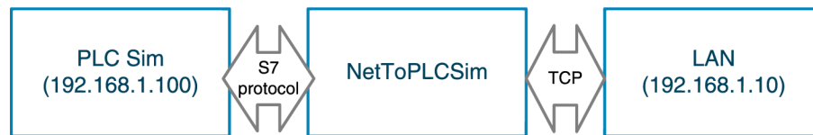
Obr. 5.5: Komunikace mezi Simulovaným PLC a místní sítí
