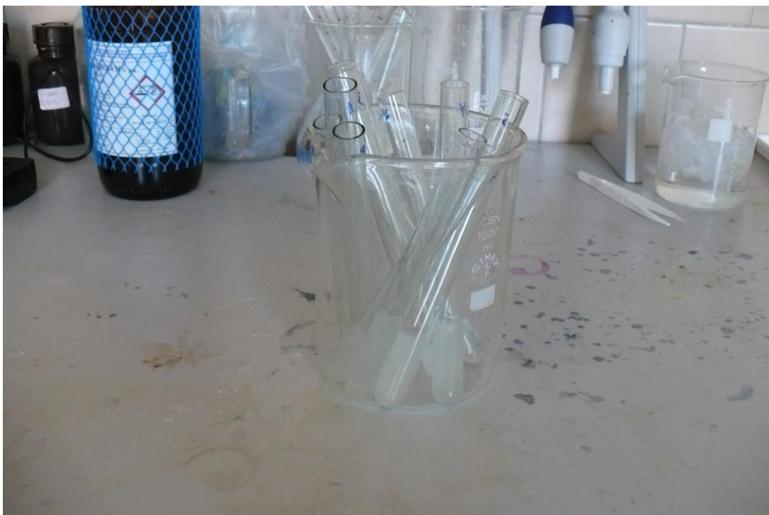
Obr. č. 30: Vzorky připravené k měření síranů ve spektrofotometru.
