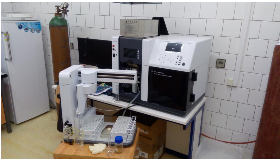
Obr. č. 32: Atomový absorpční spektrometr Agilent 55B AA – plamen pro stanovení zinku.
