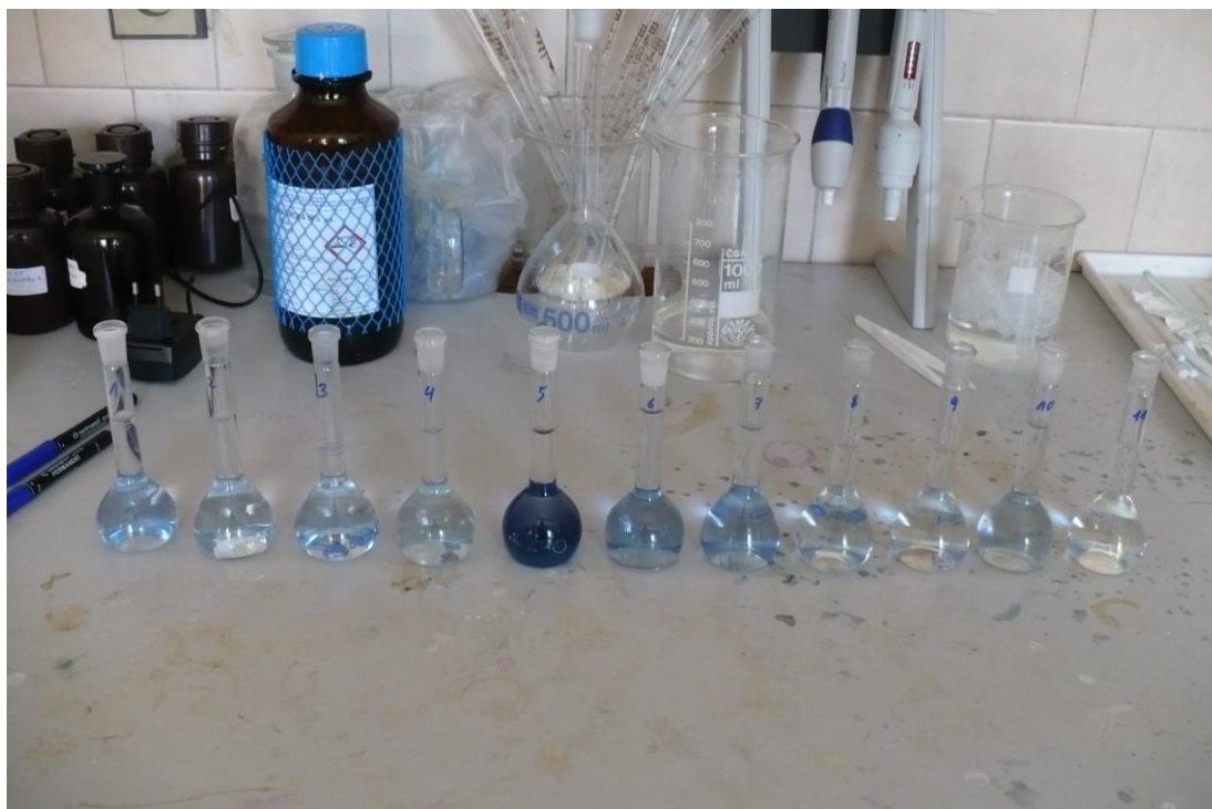
Obr. č. 29: Vzorky připravené k měření celkového fosforu ve spektrofotometru.
