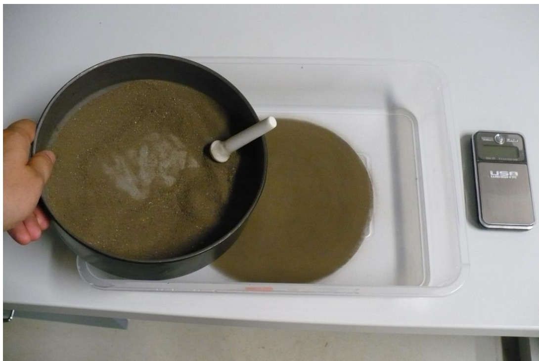
Obr. č. 44: Přesívání usušených vzorků sedimentů přes síto o velikosti ok 0,08 mm.
