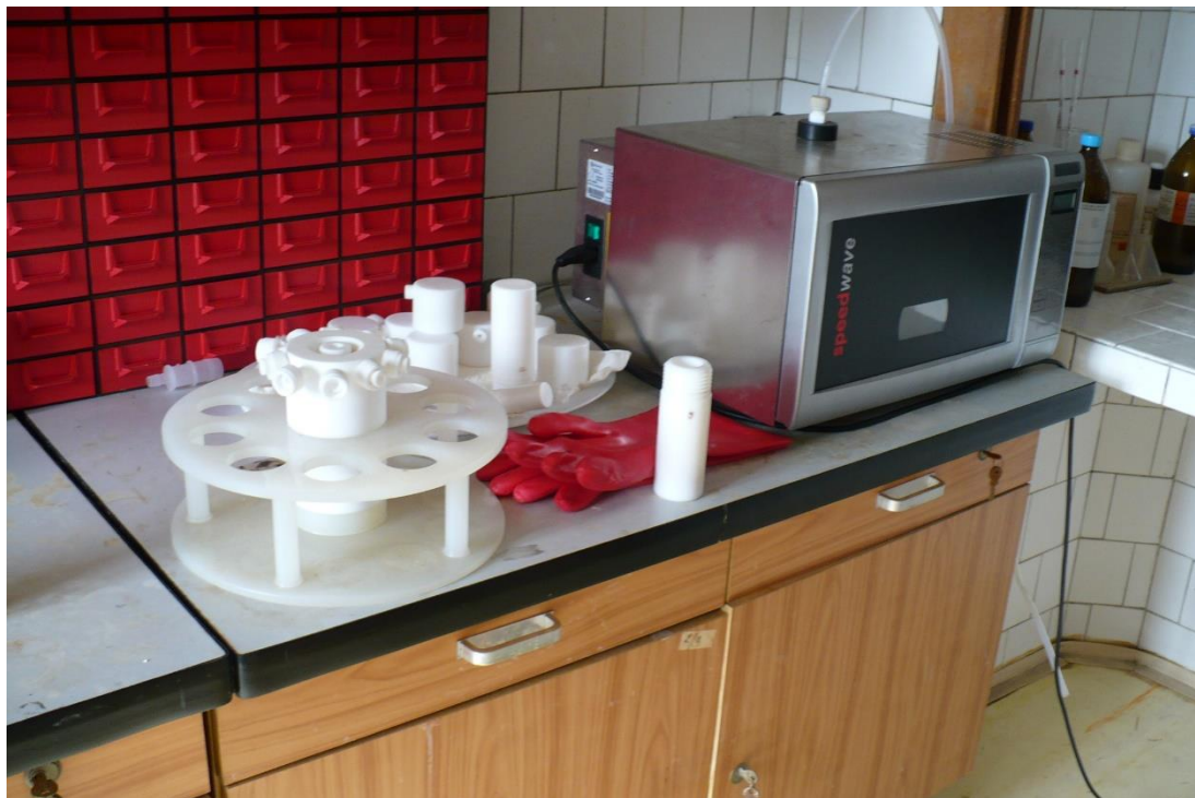
Obr. č. 45: Speciální kyvety a zařízení na mikrovlnný rozklad sedimentů.
