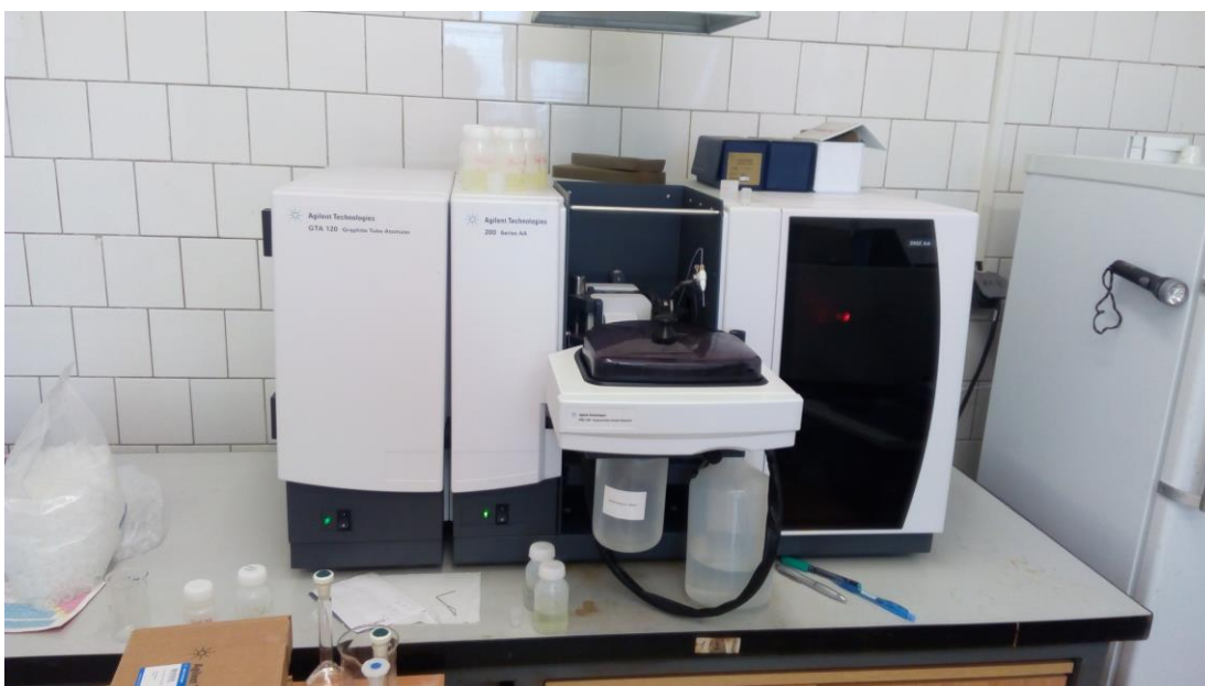
Obr. č. 33: Atomový absorpční spektrometr Agilent 240/Z – kyveta pro stanovení niklu, kadmia, mědi a olova.
