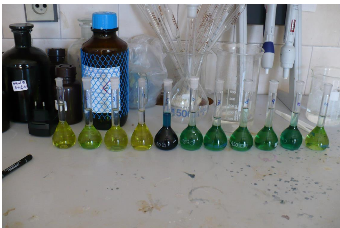
Obr. č. 28: Vzorky připravené k měření amoniakálního dusíku ve spektrofotometru.
