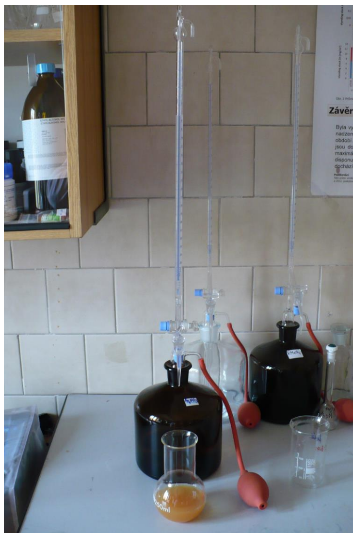
Obr. č. 31: stanovení množství chloridů v odebraném vzorku pomocí titrace.
