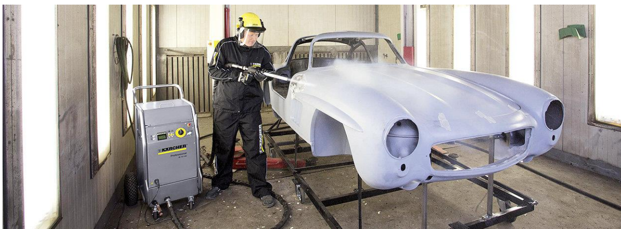
Obr. 1 Čištění suchým ledem [14]
