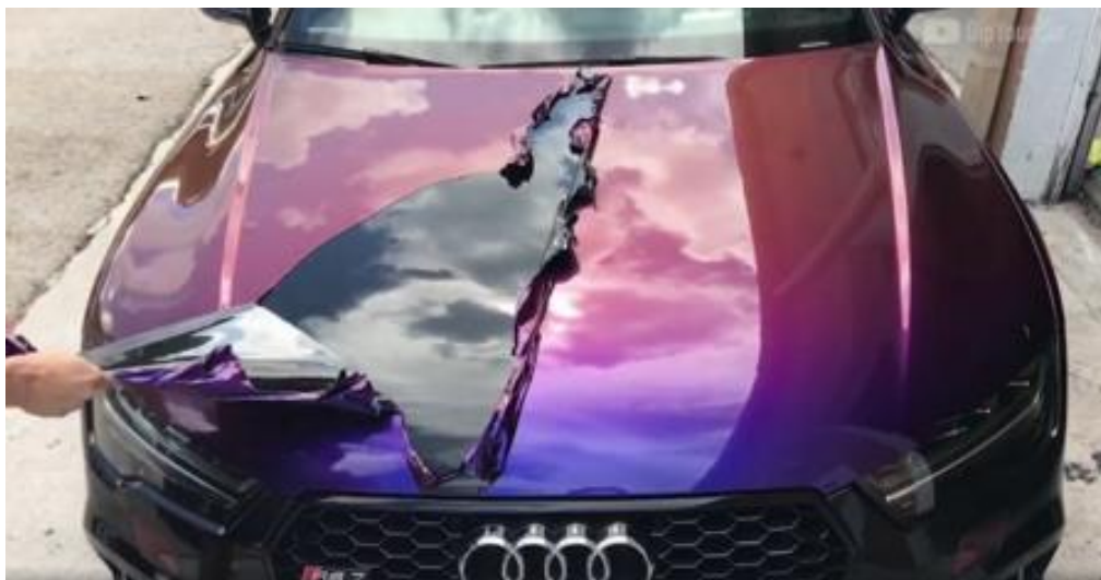
Obr. 16 Ukázka vzhledu a snadného odstranění styren butadienového nátěru [41]
