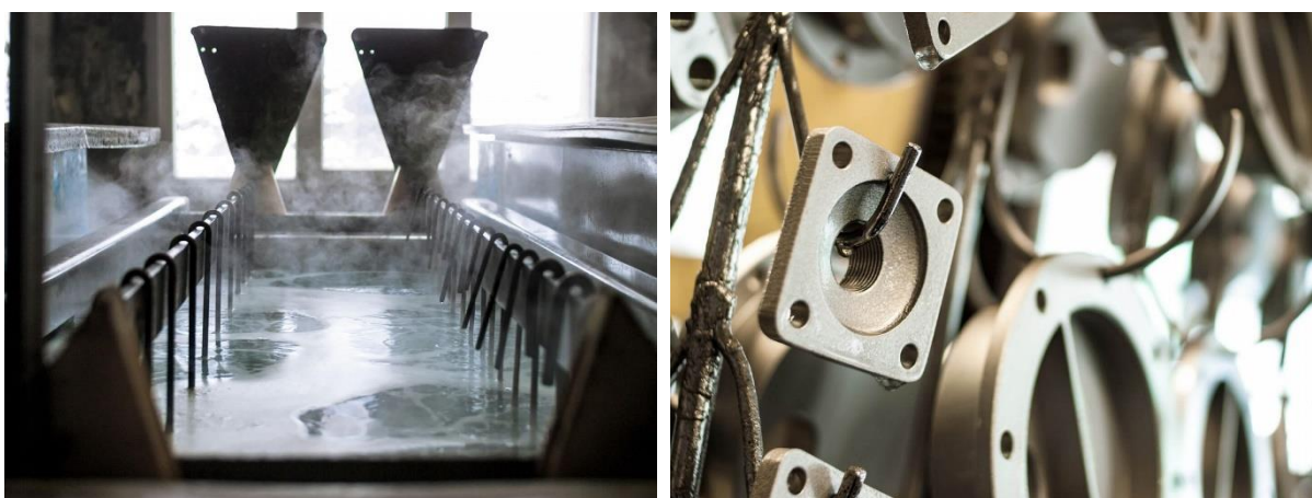
Obr. 11 Ukázky z procesu chemického niklování [32]
