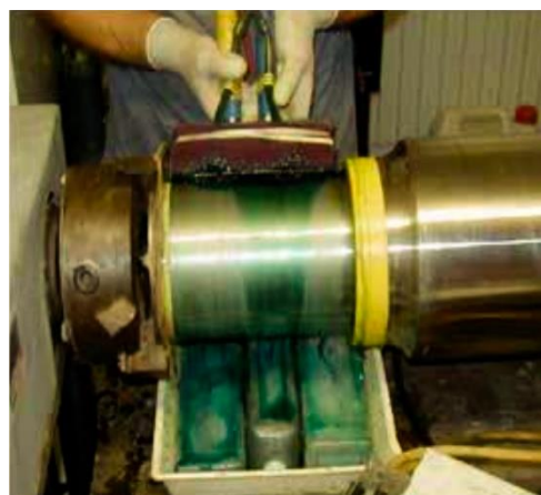
Obr. 10 Renovace nápravy kamionu niklem za pomoci tampónové technologie [30]
