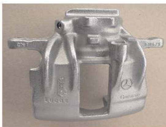
Obr. 8 Povlak zinek nikl na litinovém brzdovém třmenu [29]
