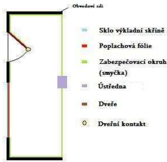
Obr. 5 Dveřní kontakt ve smyčce s poplachovou fólií
