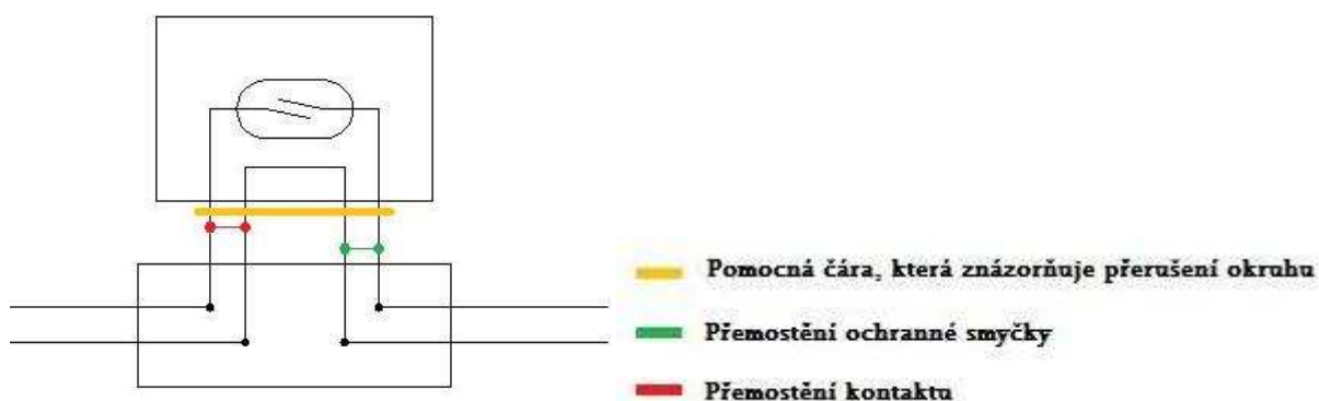
Obr. 13 Špatný pokus o přemostění kontaktu s ochrannou smyčkou
