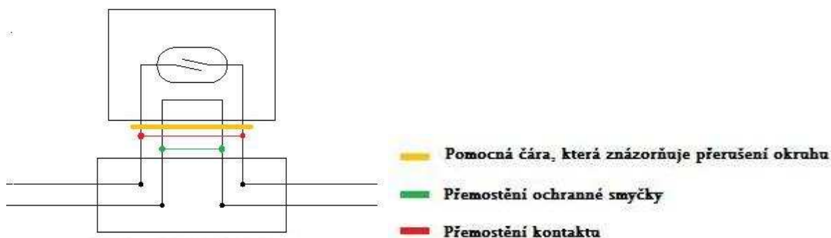
Obr. 11 Přemostění kontaktu s ochrannou smyčkou
