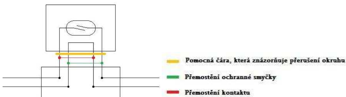
Obr. 12 Chybné přemostění kontaktu s ochrannou smyčkou
