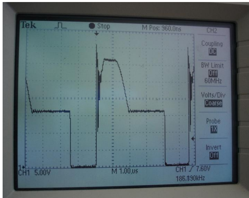
Obr. 3.1.5: Průběh napětí U_{CE} při zatížení, minimální střída
