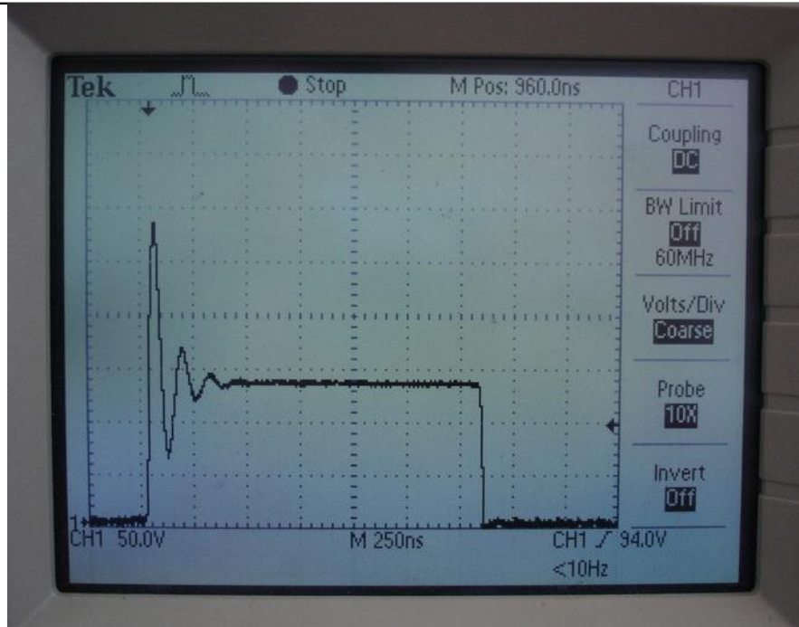
Obr. 3.2.2: Průběh napětí na nulové diodě D8 při maximálním proudu
