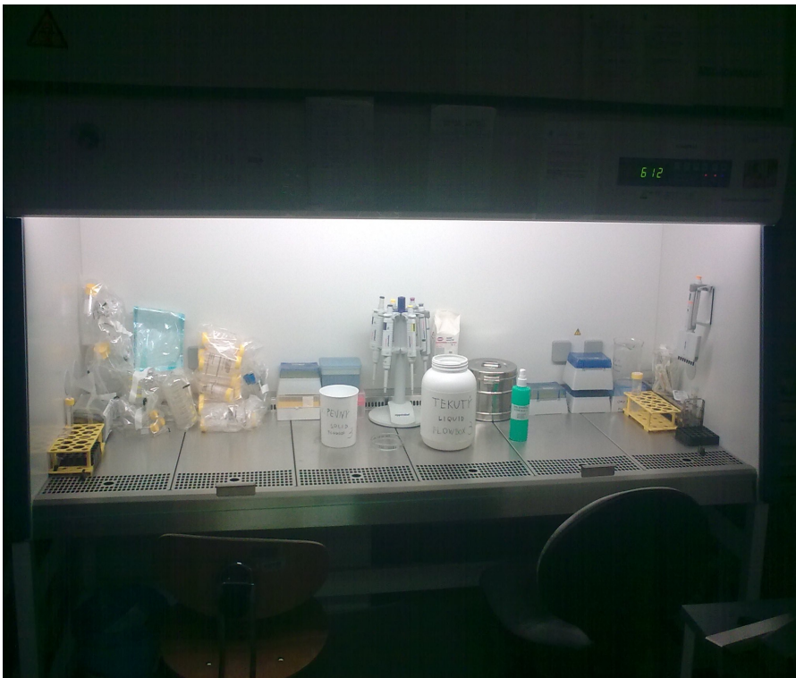
Obr. 6 Flow-box s laminárním prouděním vzduchu.
