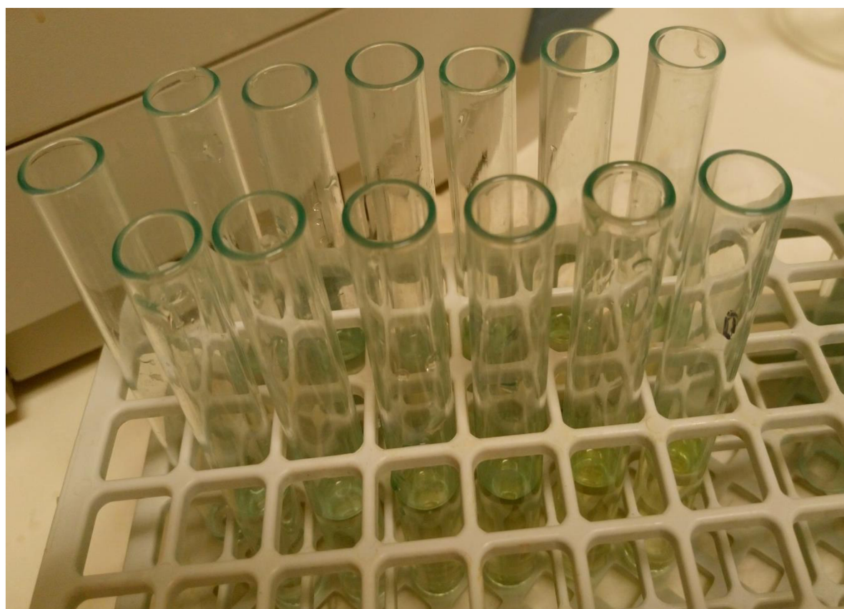
Obrázek 12: Zkumavky roztoku \text{NaCl} s vygenerovaným peroxidem, tvorba žlutého komplexu u vzorků roztoku odebrané s časovým krokem 20 s (zleva doprava).
