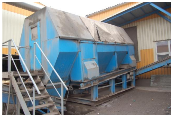
Obr. 4.2: Rotační síto [zdroj autor]
