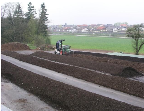
Obr. 3.5: Kompostování na volné ploše [19]
