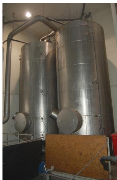
Obr. 4.4: Pasterizační jednotky [zdroj autor]
