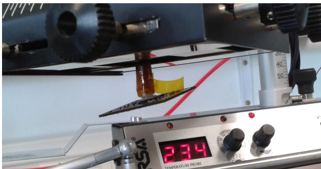
Obrázek 6.2: Demontované pouzdro přisátě na vakuové pipetě.
