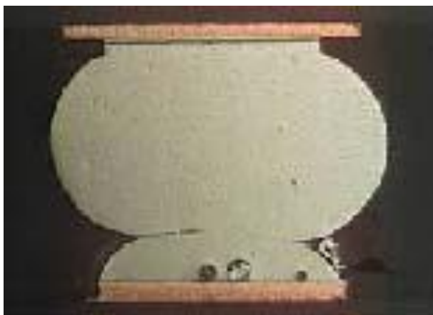
Obrázek 4.1: Head in pillow defekt (převzato z [1]).
