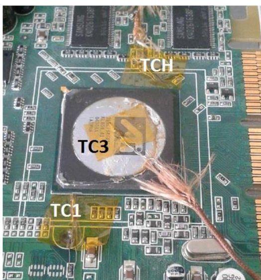
Obrázek 8.1: Rozložení termočlánků při optimalizaci teplotních profilů (zespodu TC2 a TCD).
