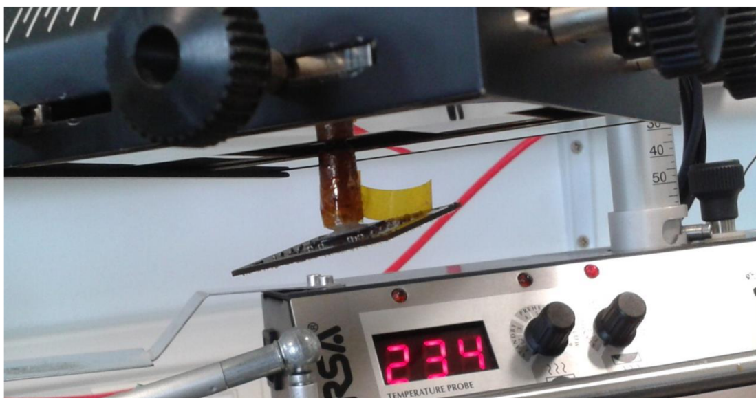
Obrázek 6.2: Demontované pouzdro přisátě na vakuové pipetě.
