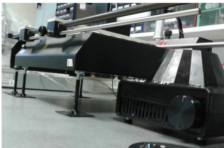
Obrázek 7.5: Stanice IR-400 usazená na ocelových nohách (vlevo) a nový chladicí modul (vpravo).
