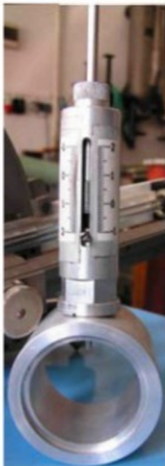
Z důvodu proměření celého rychlostního profilu směšovací komory byl sestaven Obr. 3.8: Traverzovací držák s přímou sondou 55P11; 1 - držák sondy, 2 - přímá sonda 55P11, 3 - traverzovací mechanismus se stupnicí, 4 - směšovací komora, 5 - kabel k propojení s CTA anemometrem [4]
