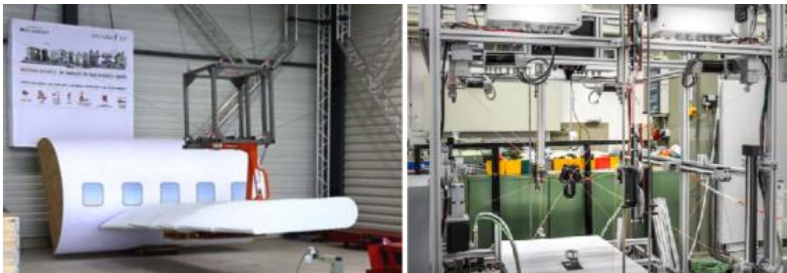
Obr. 1.13) Lanové roboty CoGiRo (vľavo) a SEGESTA Mark II extreme (vpravo)
