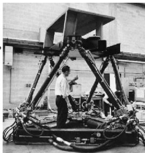
Obr. 1.8) Prvý reálny letecký simulátor s paralelnou kinematikou (K. Cappel, 1967) [10]
