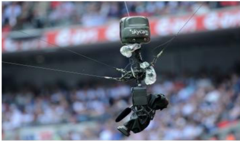
Obr. 1.12) Vľavo SkyCam - kamera pre prenos futbalového zápasu [28], vpravo schéma lanového paralelného robota využívajúca héliový balón [9]
