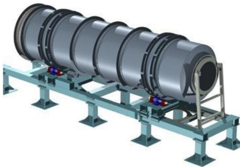
Obr. č. 6 Rotační zahušťovač (zdroj: Lyčková a kol. 2008)
