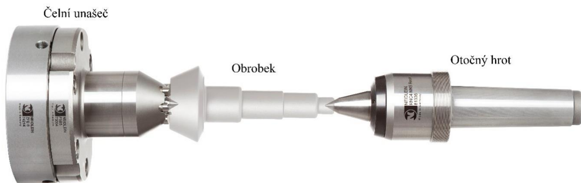
Obr. 24. Upnutí obrobku pomocí čelního unášče ze strany od vřetene a otočného hrotu ze strany od koníku, podle [23].
