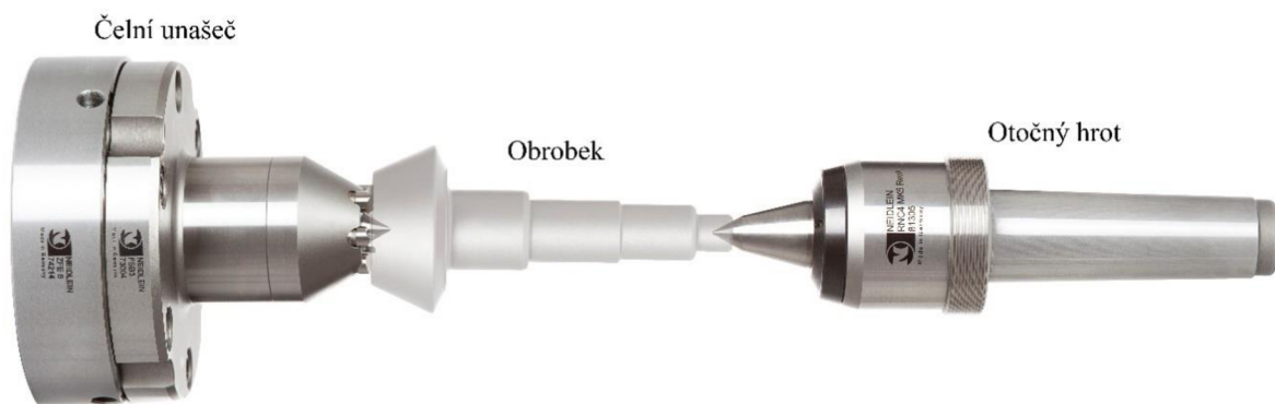
Obr. 24. Upnutí obrobku pomocí čelního unášeče ze strany od vřetene a otočného hrotu ze strany od koniku, podle [23].
