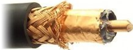
Obr. 2.12: Belden RLF10 - dvojitě opletení omezí průnik rušivých signálů do kabelu
