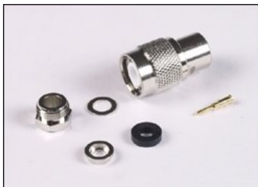
Obr. 2.14: Rozmontovaný TNC konektor.
