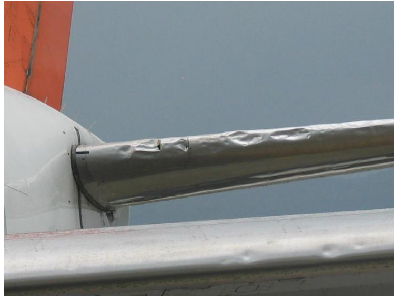
Obrázek 11: Poškození náběžných hran křídel letadla od krup (zdroj: http://www.bourky.com/ostatni-clanky/bourky-a-jejich-vliv-na-leteckou-dopravu/ )
