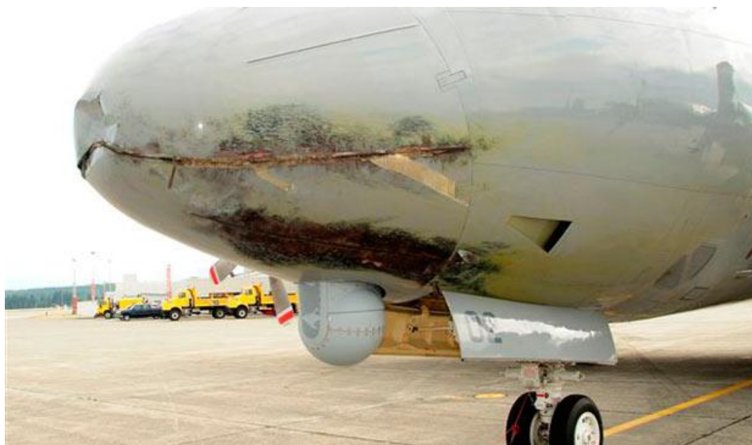
Obrázek 12: Poškození trupu letadla od blesku (zdroj: http://www.bourky.com/ostatni-clanky/bourky-a-jejich-vliv-na-leteckou-dopravu/ )
