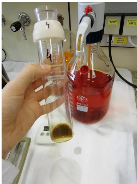
Obr. 3: vzorek půdy smíchaný s dichromanovou spalovací směsí.
