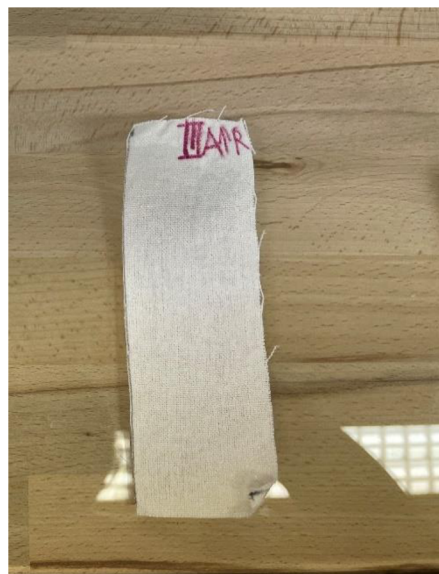
Obrázek 18 Vzorek pro měření metodou RCM
