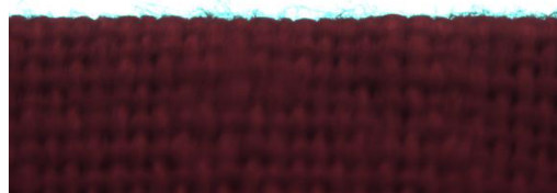
Obrázek 21 Nastavení expozice pro snímání bez chlupů
