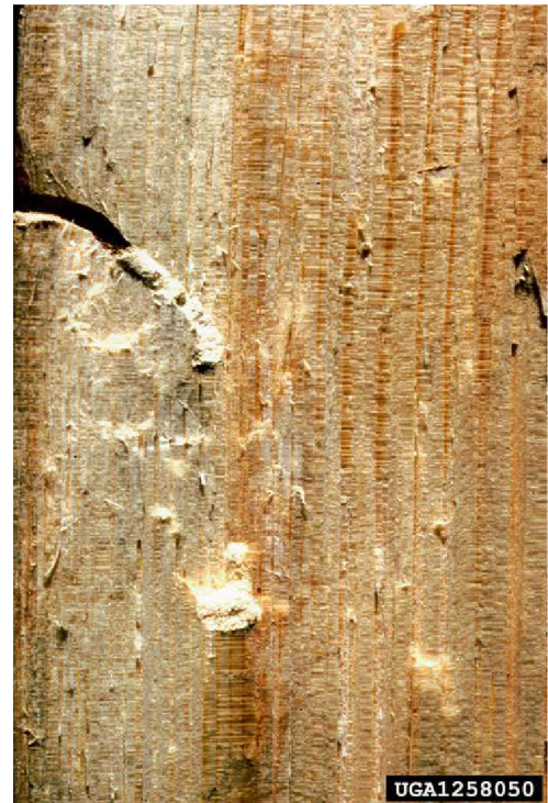
Obrázek 10 Technické poškození dřeva (Zdroj: Stanislaw Kinelski, Bugwood.org)
