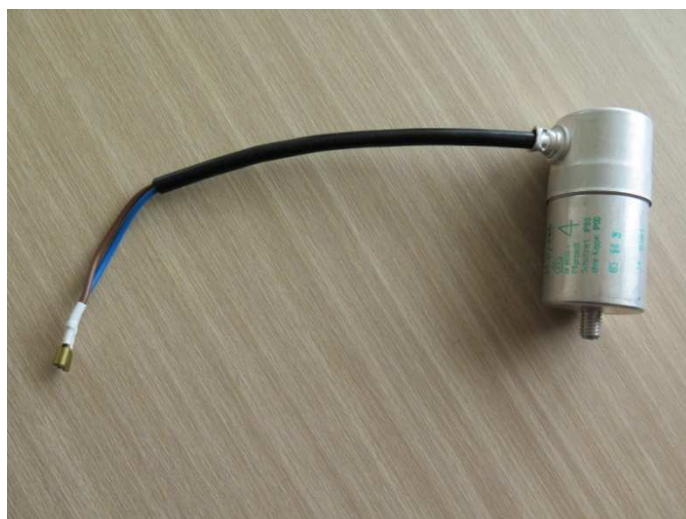
Obr. 6: Motorový kondenzátor se zvýšeným krytím Zdroj: Vlastní zpracování
