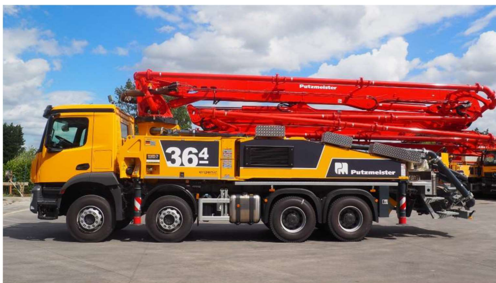
Obrázek 70 Automobilní čerpadlo betonu Putzmeister M36-4 [13]
