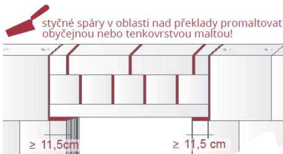
Obrázek 44 KS-QUADRO – Uložení překladů [29]
