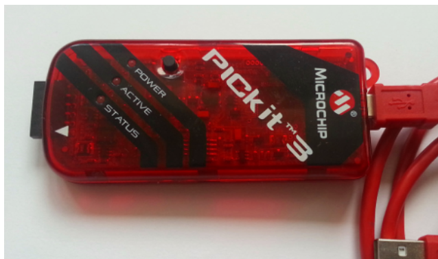
Obrázek 7.1: Použitý programátor/debugger PICkit 3 od firmy Microchip.
