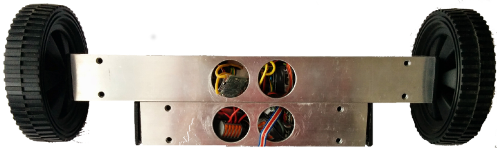
Obrázek 5.6: Základ podvozku tvořený jekly, obsahující motorové sestavy a elektroniku.
