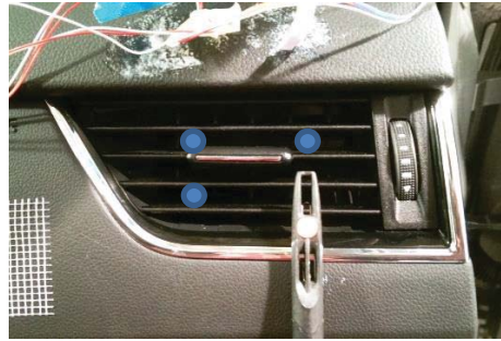
obrázok 6.7 Meranie lokálnej rýchlosti vo vytípanom mieste
