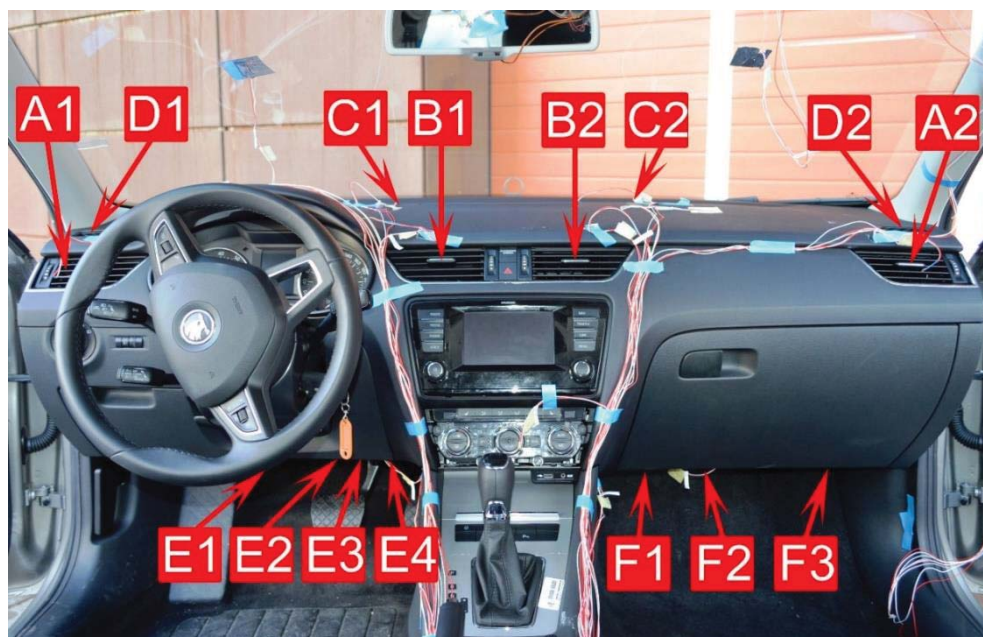
obrázok 5.4 Rozmiestnenie výustiek v prednej časti kabíny automobilu
