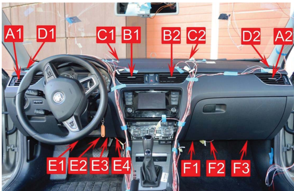
obrázok 5.4 Rozmiestnenie výustiek v prednej časti kabíny automobilu
