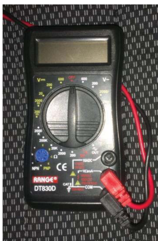
obrázok 6.11 Multimeter DT830D RANGE
