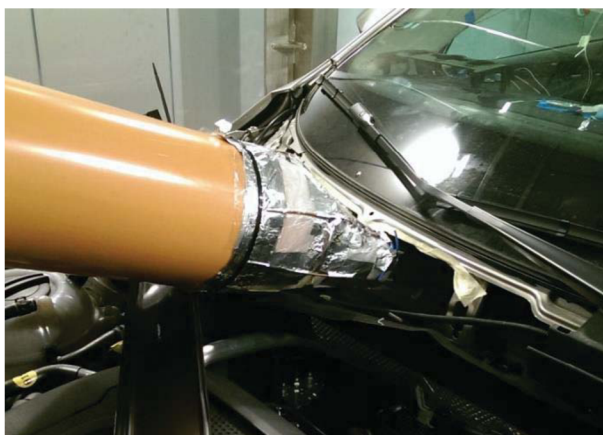
obrázok 6.3 Prechodová redukcia s ustáľovacím potrubím
