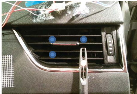
obrázok 6.7 Meranie lokálnej rýchlosti vo vytipovanom mieste
