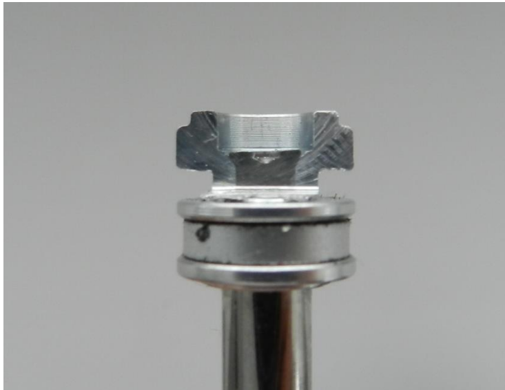
Obr. 7: Řez zakrimpované pístnice a pístu
